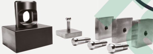
PosiTest AT 50T készlet kerámiacsempék ragasztójának szakítószilárdsága vizsgálható
